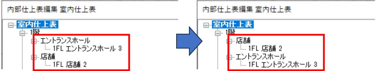
② 集計表[A04\_内部仕上表]にて、部屋順序の変更が反映されていることが確認できる
